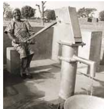
Femmes actionnant une pompe à eau à l'aide d'un manche de plus grande longueur 97
