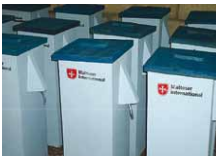
Filtres à bio-sable produits au Sri Lanka
